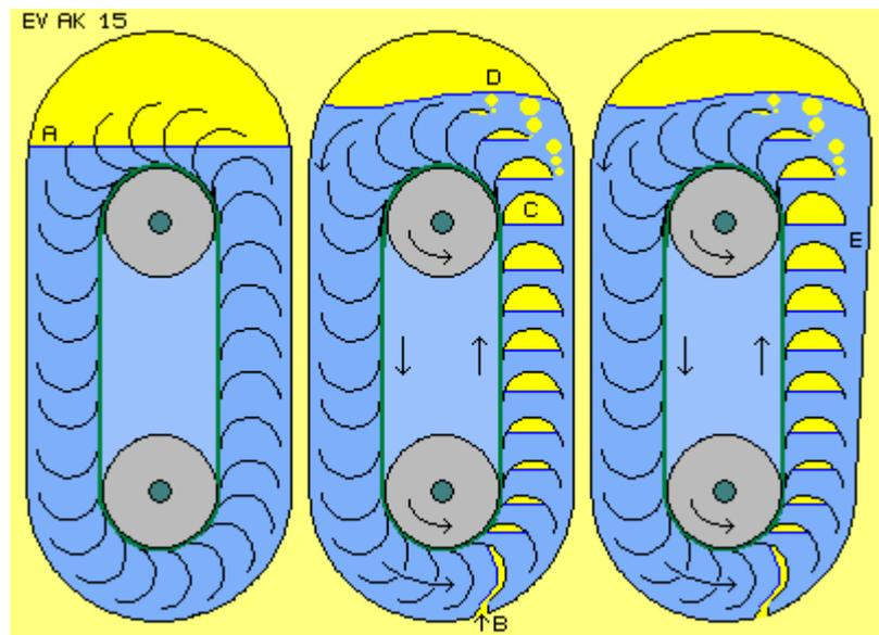
Gegenüber dem vorigen Wasserstand (bei A) wird der Wasserspiegel angehoben (bei D, etwas überzeichnet).
