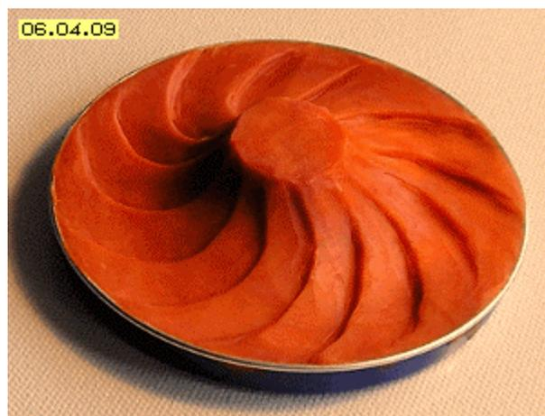
Der Zufluss ist schneller als die Drehgeschwindigkeit des Rotors. Das Fluid fliegt über die 'flachen' Seiten der Zähne hinweg, bis es auf eine 'steile' Druck-Wand trifft. An dieser entlang erfolgt die Umlenkung (letztlich auch in axiale Richtung zum Auslass). Alles Fluid trifft früher oder später auf eine solche Wand, d.h. die komplette Strömung wird in Drehmoment umgesetzt. Letztlich wird das Fluid in axialer Richtung aus der Turbine abgeführt.
